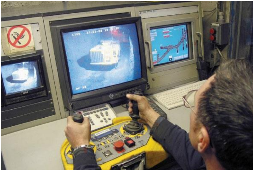
Gambar.35 Penambangan bawah tanah menggunakan mesin canggih-inovatif (Praveen Duddu 2014)
